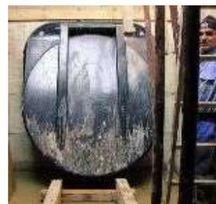
VOCE DI CAPITOLATO : Fornitura di valvola antiriflusso fine linea costruita in poliestere rinforzato e gel-cot isofoitalico , metallerie in acciaio inox AISI 316 , flangiata per accoppiamento a parete verticale ; battente inclinato ; tenuta idraulica 1 bar ; guarnizione di tenuta in EPDM
