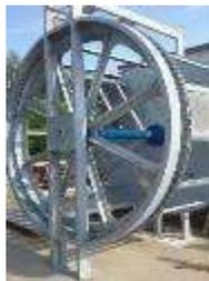
Il filtro a tamburo rotante consente una filtrazione dell'acqua asportandone i residui su acque di canale, impianti civili ed industriali; l'acqua passa attraverso la rete metallica del filtro uscendo depurata. I sedimenti depositati nel tamburo vengono eliminati da un getto di acqua pulita attraverso un convogliatore e quindi raccolti.
