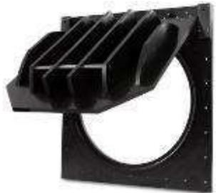
VOCE DI CAPITOLATO : fornitura di valvola antiriflusso fine linea a **sezione rettangolare o quadrata** costruita in polietilene, metallerie in acciaio inox, per accoppiamento a parete verticale ; battente verticale ; tenuta idraulica 2m H20; guarnizione di tenuta in gomma
